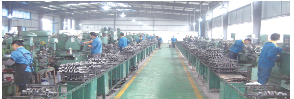
雨田机械的员工正在加工曲轴。
