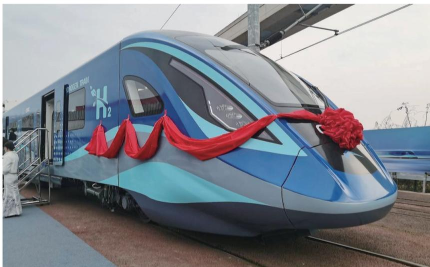
12月28日,中车长客股份公司联合成都轨道集团共同研制的具有自主知识产权的全球首列氢能源市域列车在成都下线。记者了解到,列车采用“复兴号”关键核心技术,最高时速160公里,内置“氢能动力”系统,为车辆运行提供强劲持久的动力源,可实现600公里超长续航。
