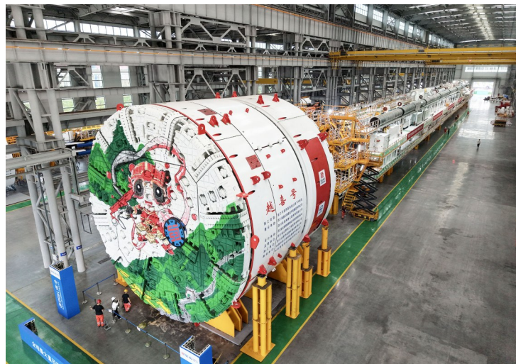
▲9月24日,全球最大直径双护盾TBM“越喜号”在成都下线。 蜀道集团供图
