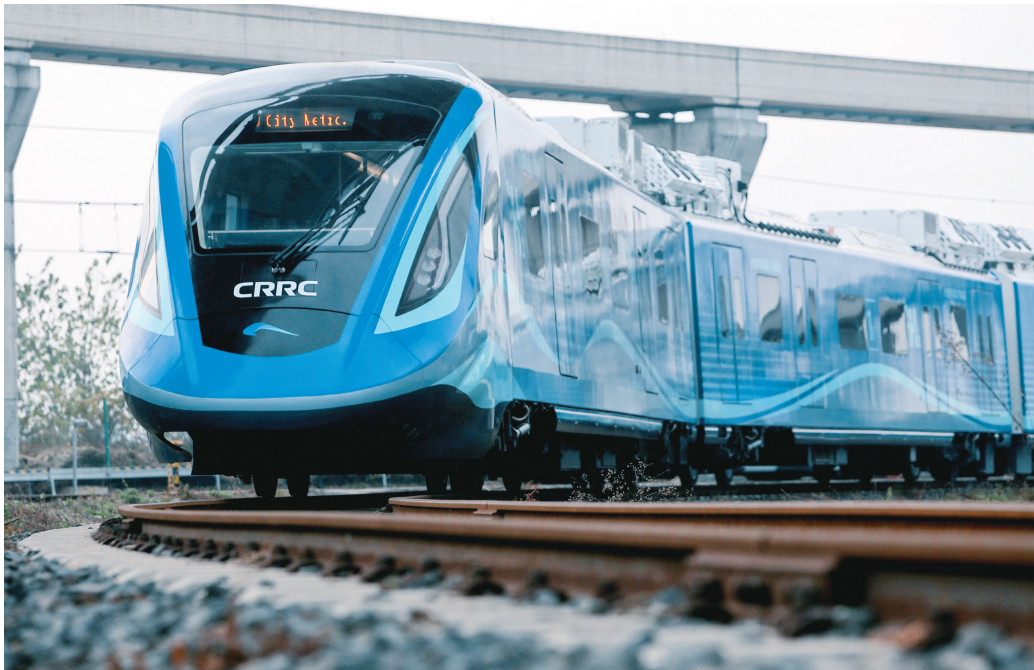
在成都新津下线的全球首列时速160公里氢能源全自动市域列车。图据新津区委宣传部
