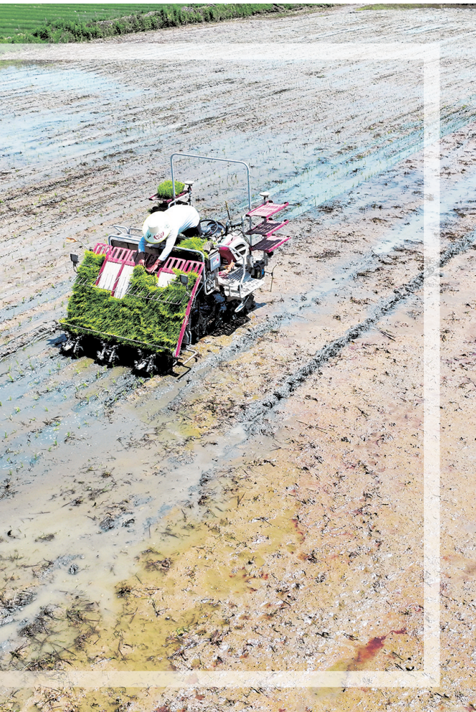
一台搭载北斗导航辅助驾驶系统的插秧机在田间作业。张勤宝 摄
