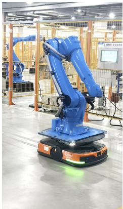
AGV小车在运输卡诺普机器人。
