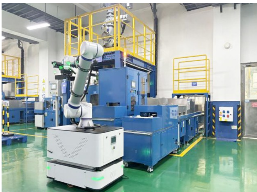
成都巴莫科技厂区，匣钵上下线机器人正在作业。受访者供图
