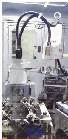
PCBA全自动智能测试设备。
