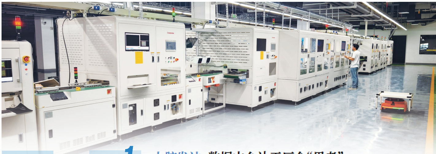
长虹新网科技生产车间AGV智能物流转运。
