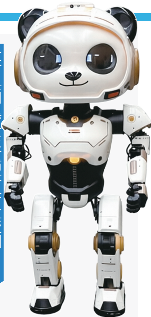
▲“竹大”的外壳和骨骼采用了竹原纤维复合材料。
