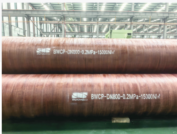
大竹县竹缠绕管廊生产车间。曾业摄
