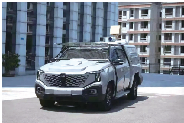
搭载四川连芯御光科技有限公司激光定向能设备的反无人机指挥车。图据成华发布微信公众号
