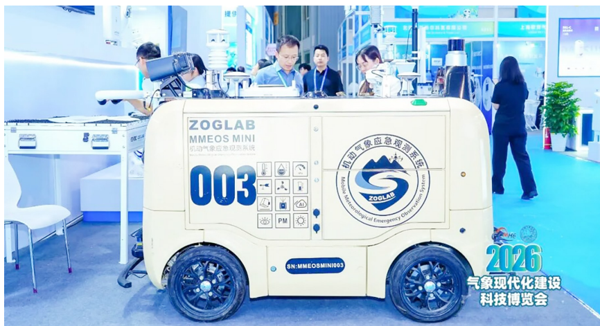
▲ Ka波段毫米波雷达。组委会供图 ▶ 集成12种气象要素探测功能的机动气象应急观测系统。组委会供图
