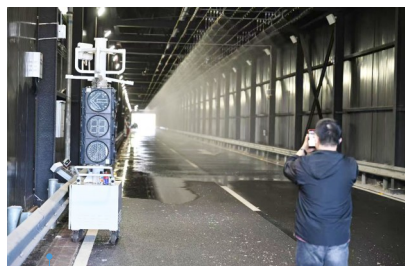
交通气象综合模拟实验室能再现降雨、积水等情景。卢荡 摄
