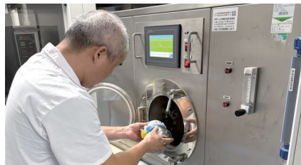
工作人员在试验过滤式消防自救呼吸器一氧化碳防护性能。图据新华社客户端
