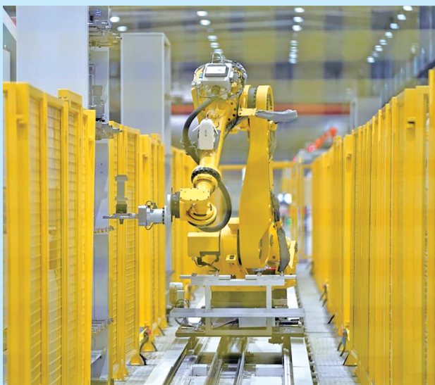
在东方汽轮机有限公司叶片加工无人车间,机械臂抓取处理好的叶片部件。
