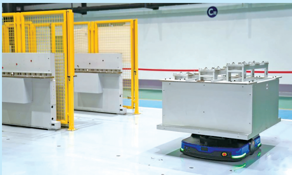
AGV小车搭载叶片部件行驶在东方汽轮机有限公司的叶片加工无人车间。
