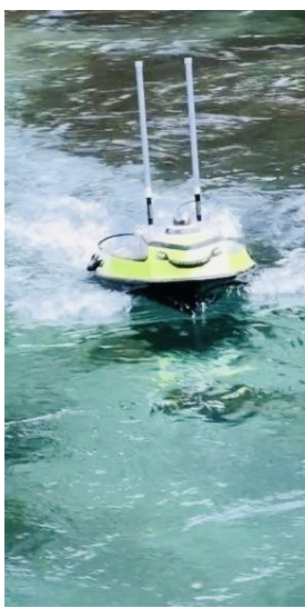
ADCP无人船九寨沟测流。徐瑛蔓 摄
