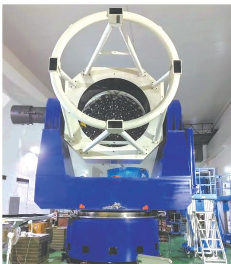
建造中的“2.5米大视场高分辨率太阳望远镜”本体。
