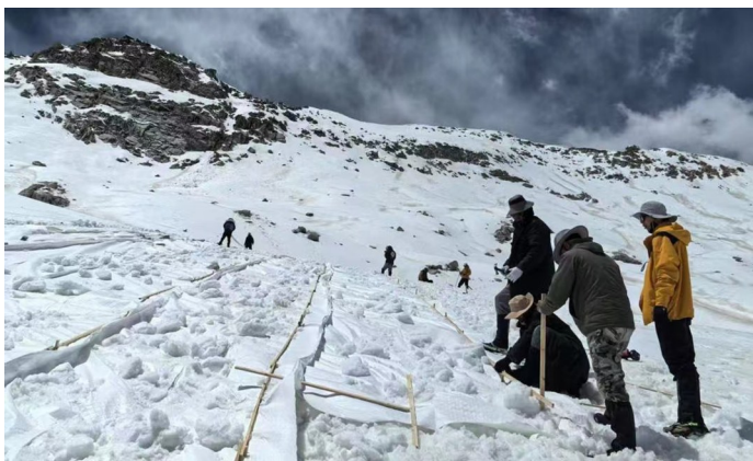
科研人员给达古冰川铺设辐射制冷纳米材料白色被子。受访者供图
