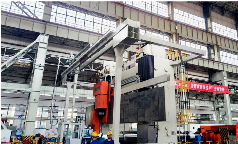
东方电机大型清洁能源装备重型制造数字化车间的数控立车。
