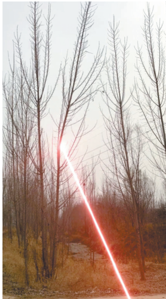
工作中的激光清障仪斩断树干。
