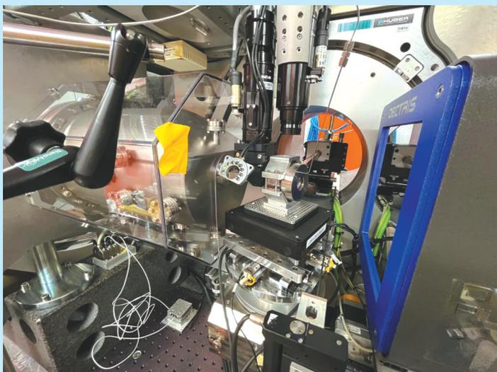
给氢加压这项研究使用了瑞典MAX IV(最新一代同步辐射光源)的NanoMAX线站提供的纳米聚焦X射线，图为射线聚焦装置、样品台、光子计数探测器。 受访者供图
