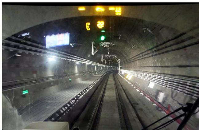
地铁13号线的电客车正在进行热滑试验。成都轨道集团供图
