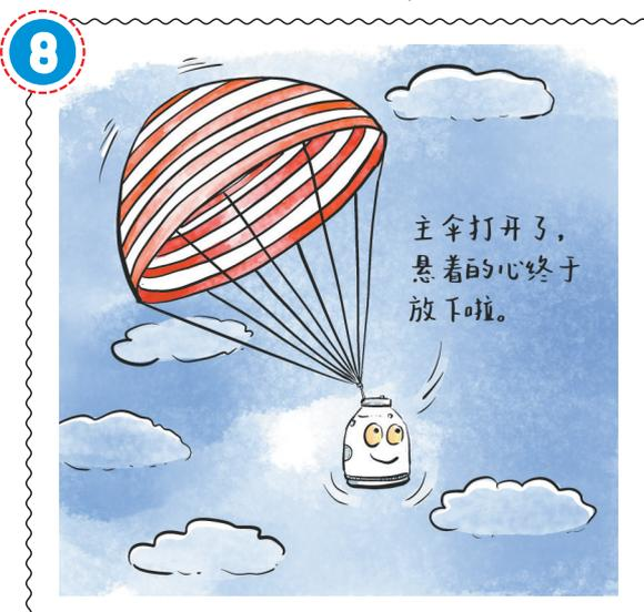
返回舱在距地面10千米左右时，回收着陆系统启动。返回舱先打开伞舱盖，然后依次拉开引导伞、减速伞和主降落伞。在返回舱距离地面8千米时，主降落伞打开，把返回舱速度由每秒60至70米减至每秒5至6米。
