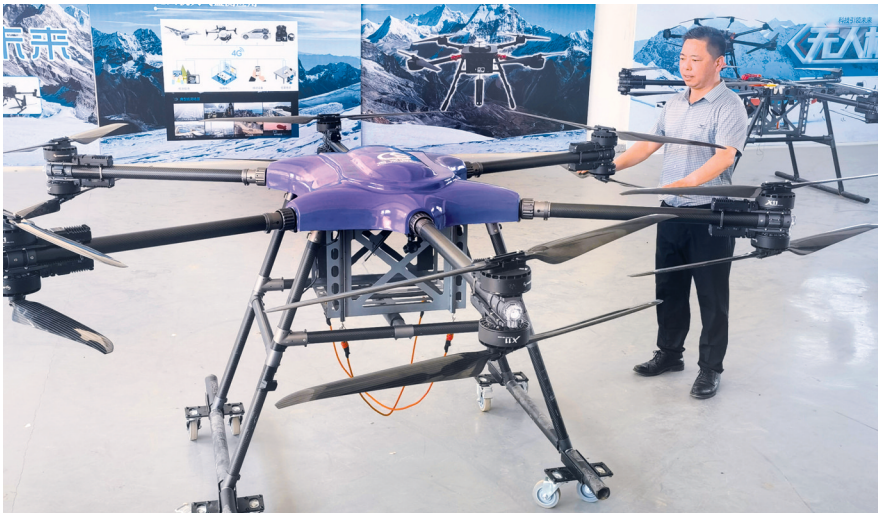
何进介绍“鱼鹰”水质自动采样无人机。受访者供图
