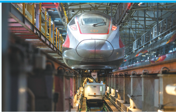
在湖南长沙动车运用所，动车组车底检测机器人在检查动车组车底情况。
