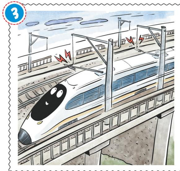
我国的高铁列车基本靠电力“奔跑”,而它们获取电能的方式很有趣——车顶上那个像小手臂一样的东西,叫受电弓,它就像是高铁的“能量吸管”,从上方电网“吸”取电能。
