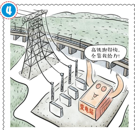
高铁沿线每隔50公里左右就有一座牵引变电站,它们就像“电压魔法师”,发电厂送来的高压电到了这儿,被转换成合适的电压,然后通过接触网这个“能量传输带”,把电能传给列车。
