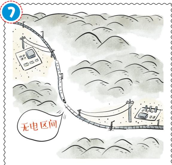
坐高铁时,可能有旅客发现,有时电子设备突然有几秒充不上电,这其实是为防止相邻牵引变电站供电线路短路,在变电站之间设有200米左右无电区域。高铁以时速250公里穿过无电区域,大概就3秒钟。
