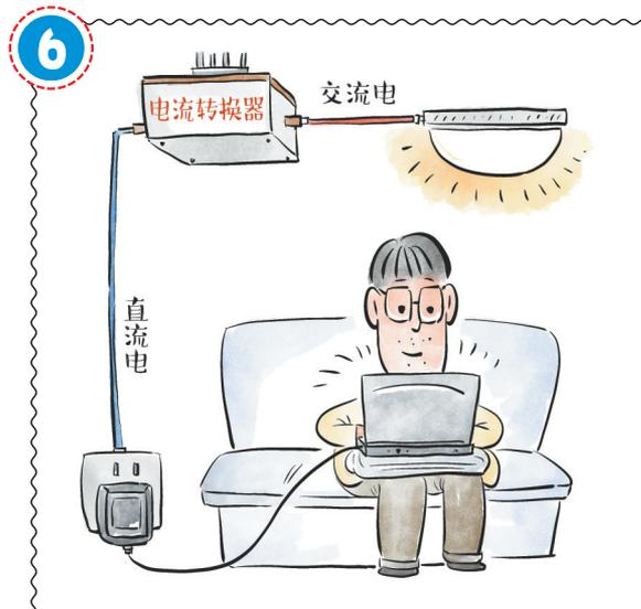
接着,再通过交直流转换装置这个“电流转换器”,把电流变成我们熟悉的电压220伏、频率50赫兹的单相交流电,然后输送到列车各个电源插座。这样,旅客就能用插座给手机、电脑充电了。
