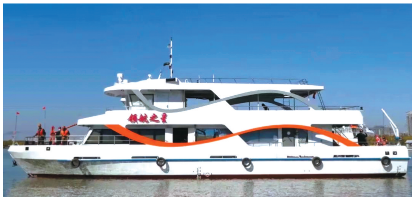
国内首条采用磷酸铁锂电池的寒地电推船“领航之星”。图据哈尔滨工程大学公众号
