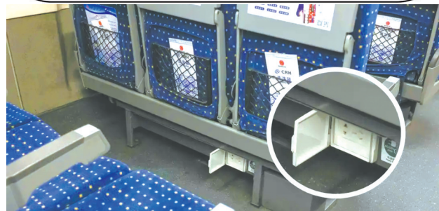
动车上可为手机充电。以CRH2G型动车为例,二等座电源插座通常在前排座椅靠背下方。图据昆明铁路微信公众号
