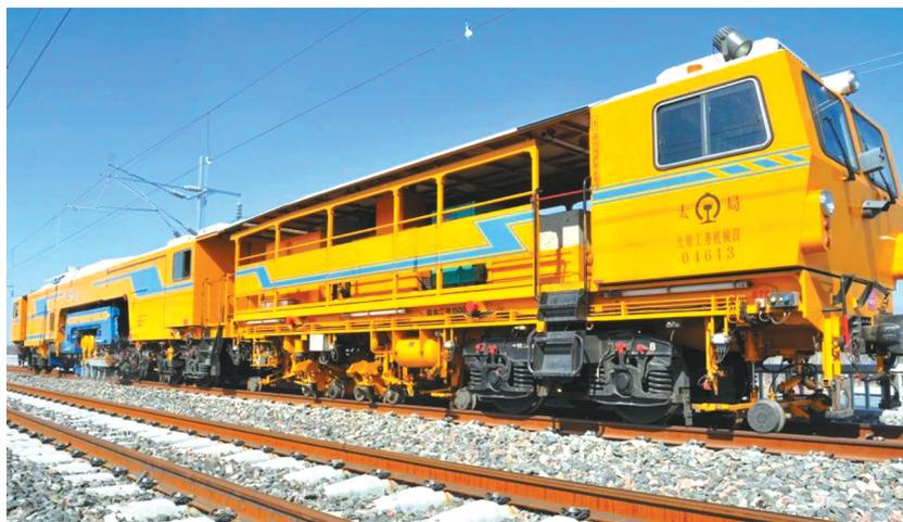
线路捣固车。图据太原铁路微信公众号
