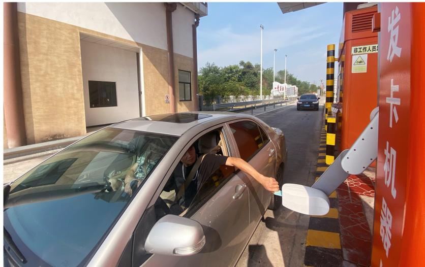
AI智能机械臂发卡机器人正在发卡。蜀道集团供图
