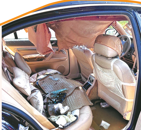
在杭州消防萧山救援大队做的实验中，“降温神器”引发爆炸，车厢内一片狼藉。图据杭州日报
