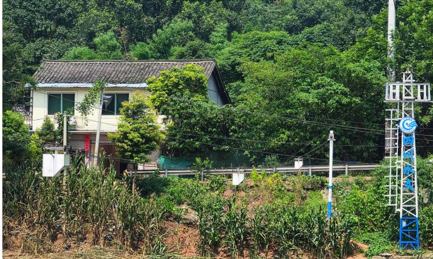
成都水文中心大邑水文站架设的固定式雷达测流仪。
