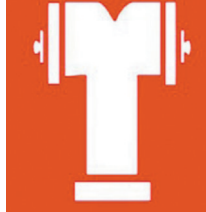
消防水泵接合器
