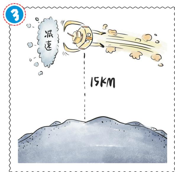
**主减速段：**在距离月面约15公里高度时，开始进入主减速段，任务就是“减速制动”，整个主减速段“着上组合体”基本呈现与月面平行的姿态飞行。
