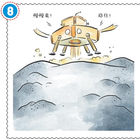
**缓速下降段：**当降至着陆点上方约30米处，速度减为每秒2米。离月面约2米时，“着上组合体”主发动机关闭，最终，四条缓冲着陆支撑腿稳稳地落在月背南极-艾特肯盆地。
