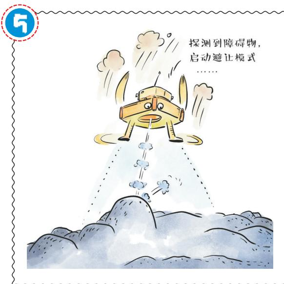
**接近段：**距离月面大约两三公里高度时，利用“光学成像敏感器”来进行“粗避障”，也就是对着陆区域的障碍物进行检测与机动规避。
