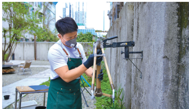
对车架连接部位进行手工打磨。
