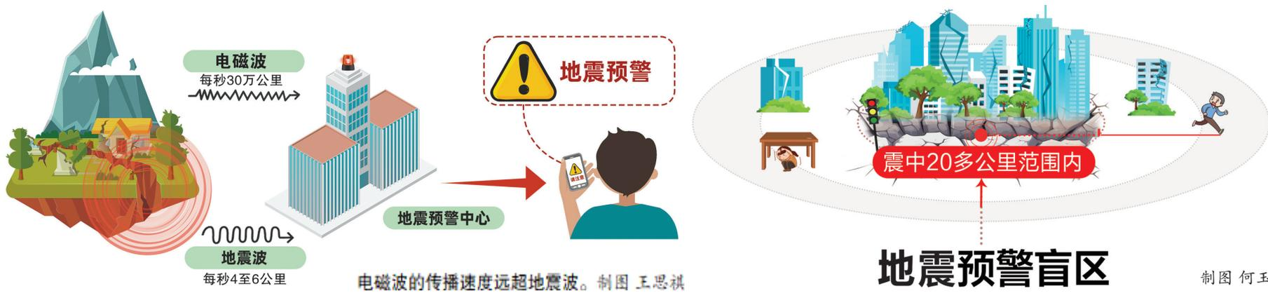
电磁波的传播速度远超地震波。制图 王思祺
