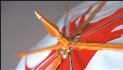
伞的尖端造型物由3D打印而成。
