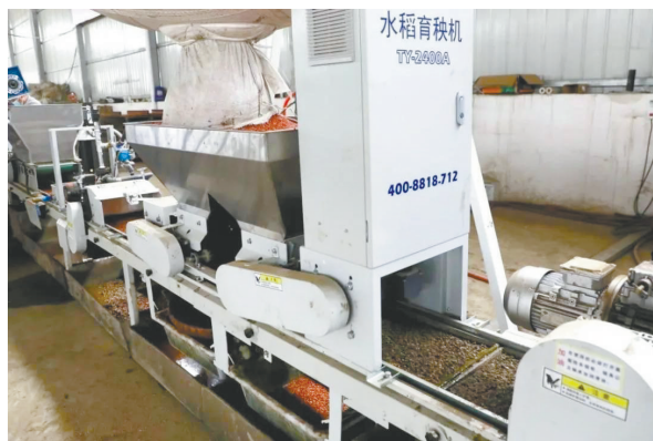
新津宝墩镇玉龙村水稻育秧基地的数字化智能育秧生产线。 图据成都新津微信公众号
