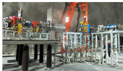
中国锦屏地下实验室二期的锦屏深地核天体物理实验 JUNA 离子注入装置。
