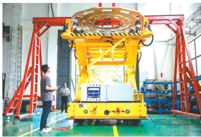
工作人员在调试馈源接收机拆装机机器人。
