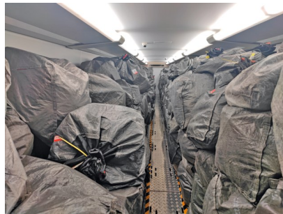
这是一辆“改造”动车,拆除了全列座椅和行李架,主要服务于生鲜食品、商务急件等货物。
