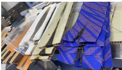
经过防火试验的飞机壁板、座椅布料、地毯等样本上,都留下了明显的燃烧痕迹。
