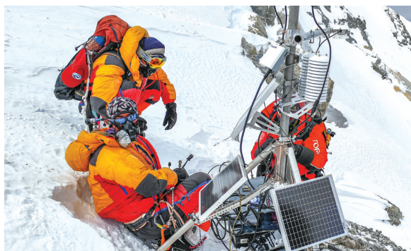
科考登顶队员在珠峰海拔约8830米处维护升级自动气象站。 新华社发
