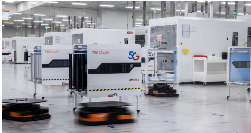
生产线上随处可见“忙碌”的IGV小车,它们常走的路线因此被磨出了痕迹。
