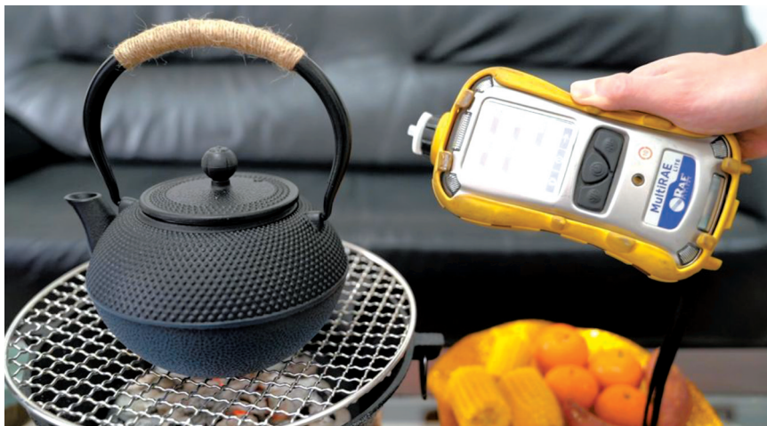
消防人员做实验检测室内围炉煮茶的一氧化碳浓度。图据新华社客户端
