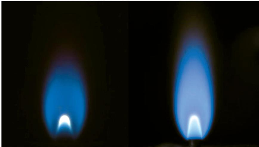
空间站燃烧科学实验柜甲烷燃烧图像(左)与地面同种工况甲烷燃烧图像(右)。图据新华社客户端
