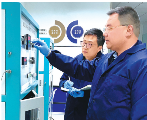
研发团队开展高温、高压情况下，颗粒在裂缝中导流能力实验。
