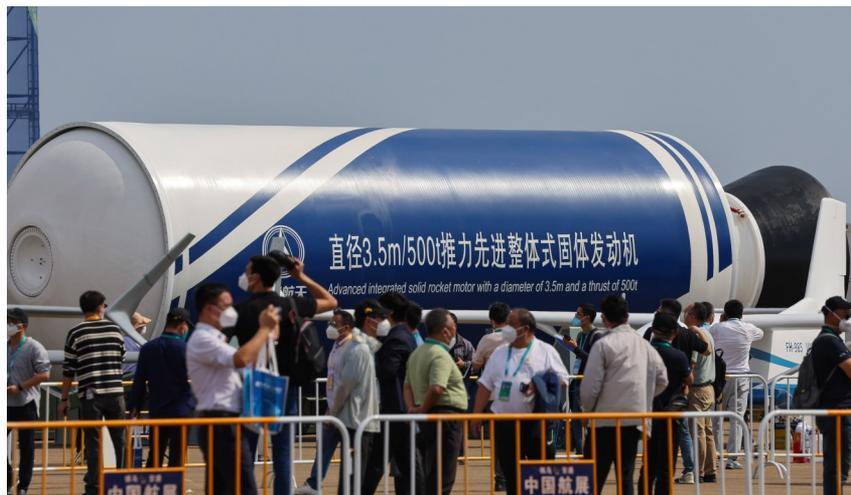
直径3.5米、500吨推力先进整体式固体发动机亮相中国航展(11月9日摄)。新华社发
