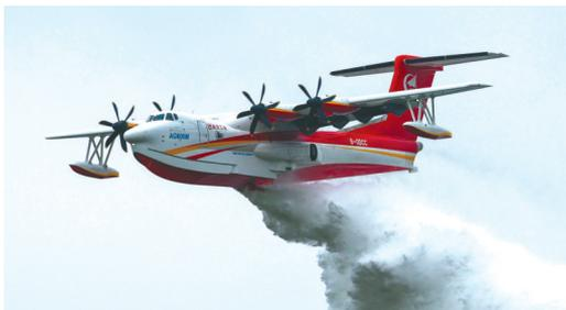
国产大型灭火/水上救援水陆两栖飞机AG600M
