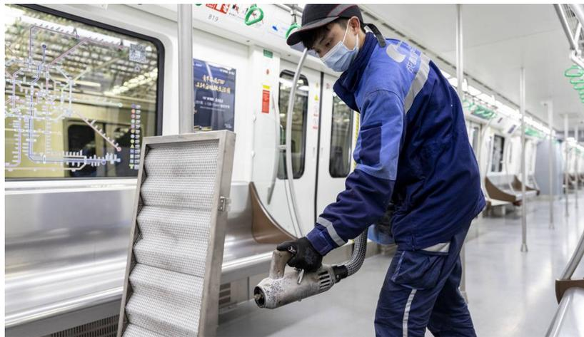
检修人员对回风滤网安装框进行消毒。成都地铁供图
