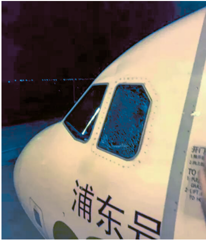
图片显示，HO1231航班机长座位左后侧风挡玻璃外层出现龟裂裂纹。
